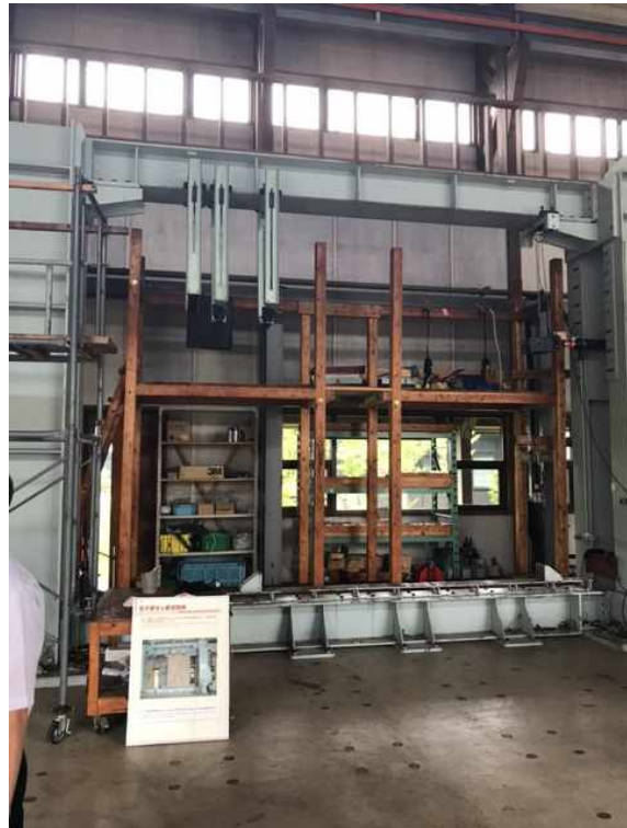
목재 벽체의 전단변형력을 시험할 수 있는 장치 태풍과 지진에 강한 구조를 만드는 것이 목표임.
