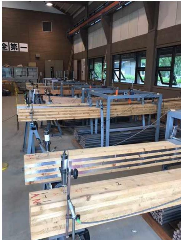
장시간 동안 무게를 주어 얼마나 휘는지 측정함. 긴 시간동안 실험을 설계해야 함.
