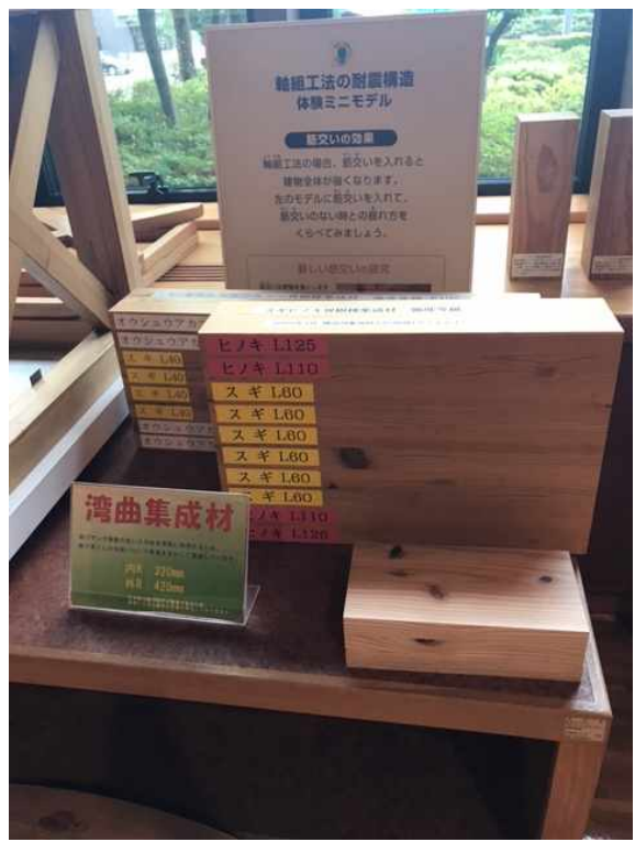
삼나무와 편백의 집성재. 삼나무만 이용하는 것보다 단단하고 편백만 이용하는 것보다 싼.
