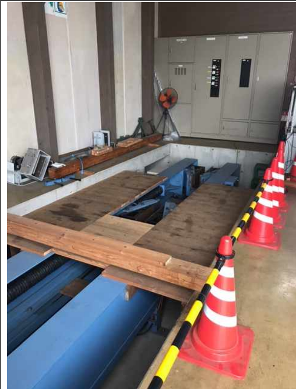
목재제품의 인장력을 시험할 수 있는 장치. 모형이 아닌 큰 크기의 제품을 시험할 수 있음.
