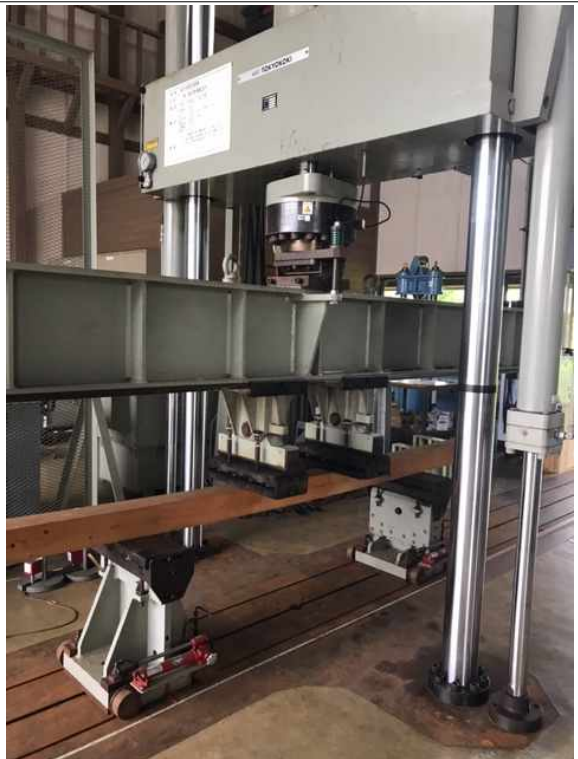
바닥과 벽에 시공되는 구조재의 횡단력을 측정함. 모형이 아닌 큰 크기의 제품을 시험할 수 있음.
